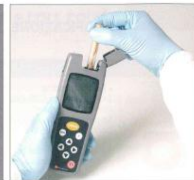
Figura 5 inserimento provetta nel bioluminometro
