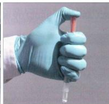
Figura 4 i reattivi e il tampone vengono messi in contatto all'interno della provetta
